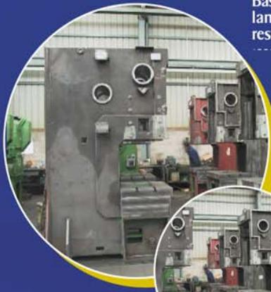
Bastidor monolítico en acero laminado soldado de alta resistencia
